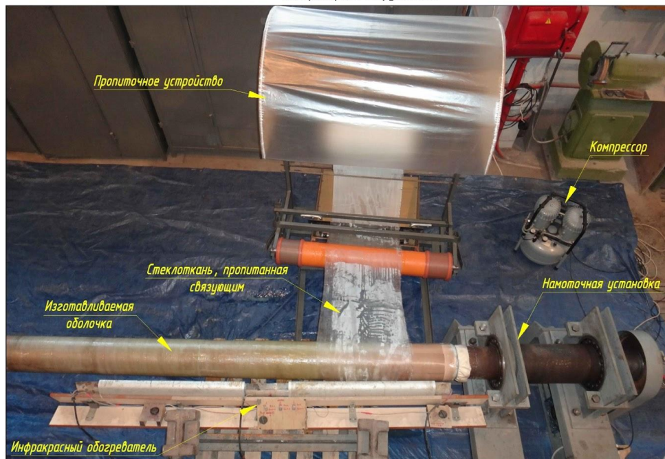
3 Приформовывание следующего участка оболочки
