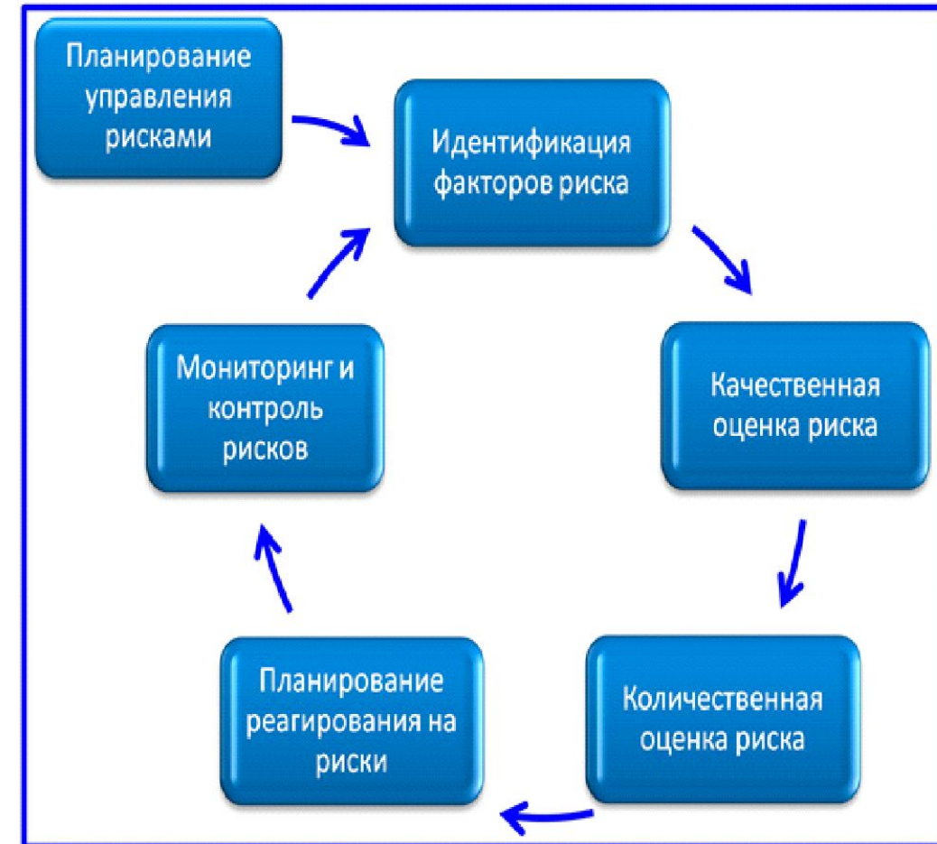
Схема процессов управления проектными рисками по PMBOK
