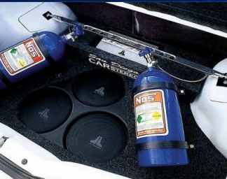
Система впрыска закиси азота для повышения мощности автомобиля
