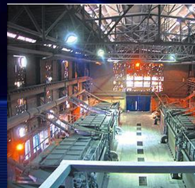
Промышленные ванны для электролиза
