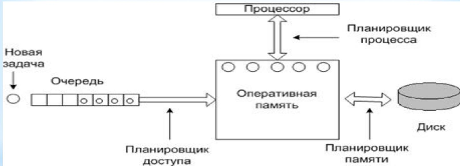
Планировщик доступа выбирает задачи оптимальным образом (например: процессы, ограниченные процессором и вводом/выводом).
