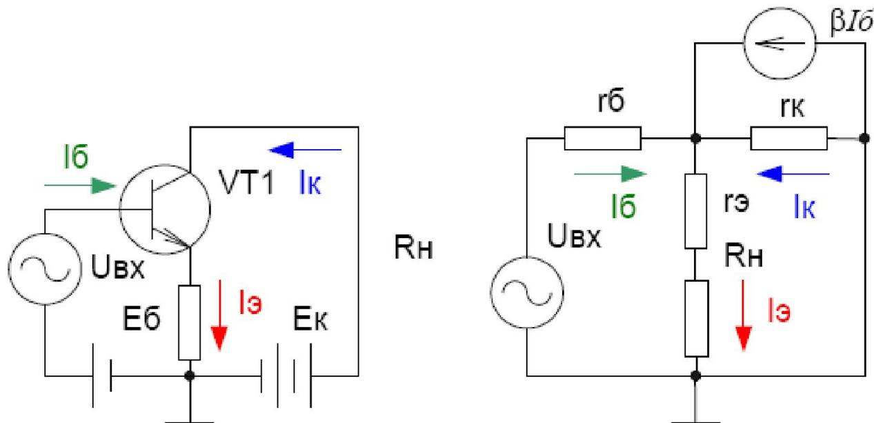
Рис.3 Включение транзистора по схеме с ОК и его эквивалентная схема
