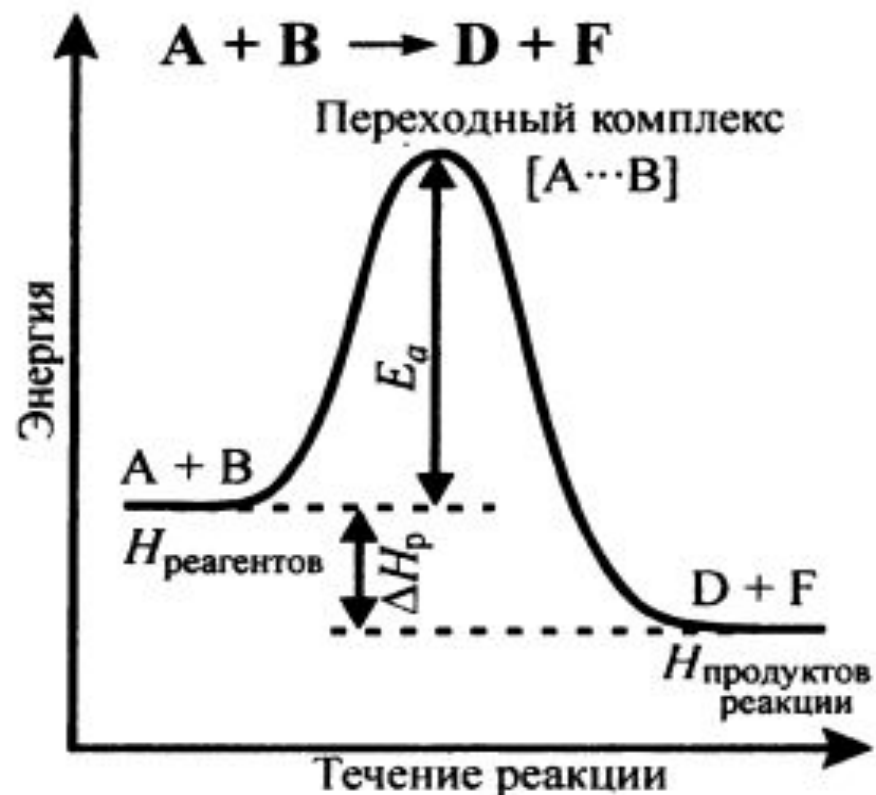
Рис. 3 . Энергетический профиль течения реакции
