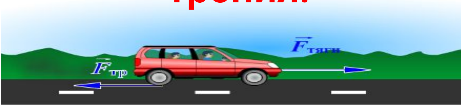
Направление действия силы трения
