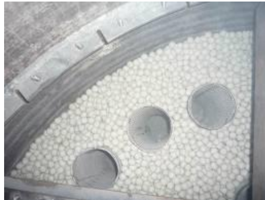
Рисунок 6. Двухсекционный реактор гидроочистки дизельного топлива
