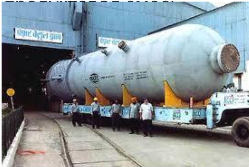
Рисунок 8. 130-ти тонный реактор гидроочистки дизельного топлива
