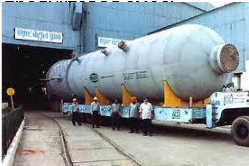
Рисунок 8. 130-ти тонный реактор гидроочистки дизельного топлива
