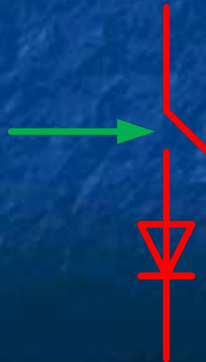
Схема замещения тиристора
