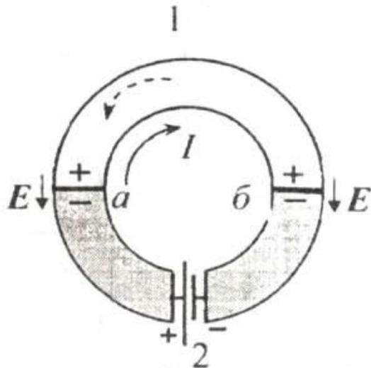
Поскольку ток в данном случае идет по часовой стрелке (так подключена ЭДС), движение электронов в цепи происходит в противоположном направлении (пунктирная стрелка).
