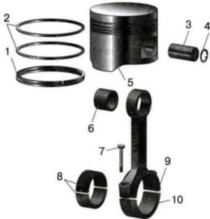
Устройство поршня: 1 - маслосъемное кольцо; 2 - компрессионные кольца; 3 - поршневой палец; 4 - стопорное кольцо; 5 - юбка поршня; 6 - втулка; 7 - болт ; 8 - вкладыши; 9 - шатун ; 10 - крышка шатуна
