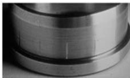
Бринеллирование дорожек качения
