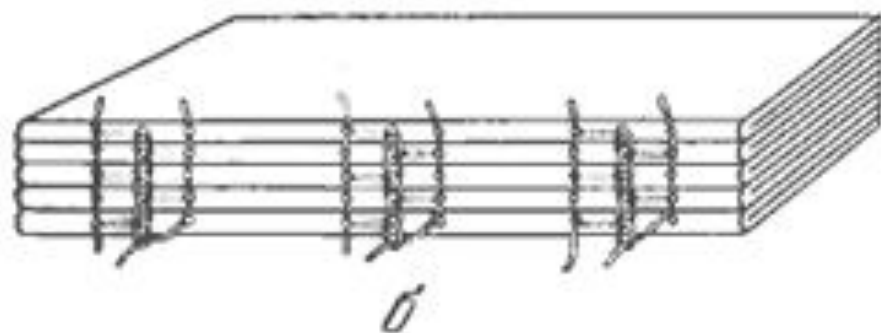
Рис. 77. Виды брошюрных стежков нитками: а — простой брошюрный стежок; б, в — переставной стежок.
