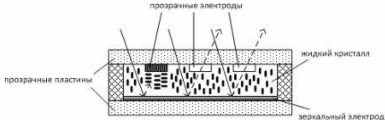
Одновременное сочетание свойств жидкости (текучесть, каплеобразование) и кристалла (оптическая анизотропия) некоторых веществ в определенном диапазоне температур между точкой кристаллизации и точкой превращения в однородную жидкость
