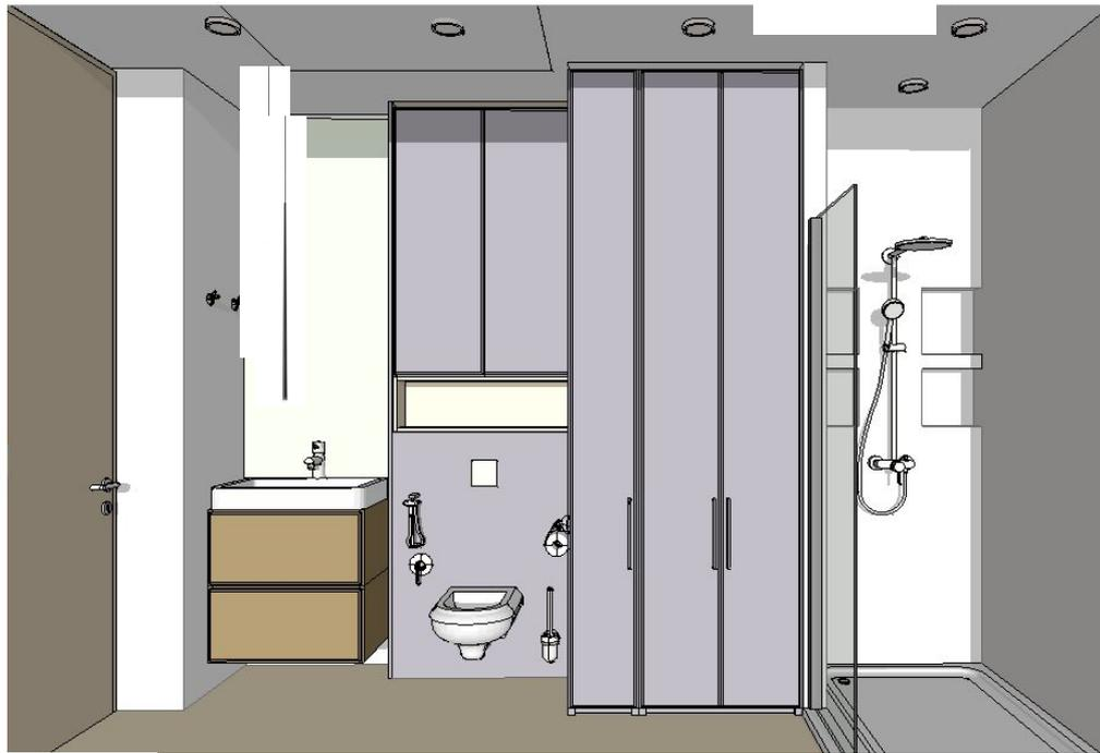
Плитка крупноформатная 3000x1000 на стене в душевой напротив входа и на полу
