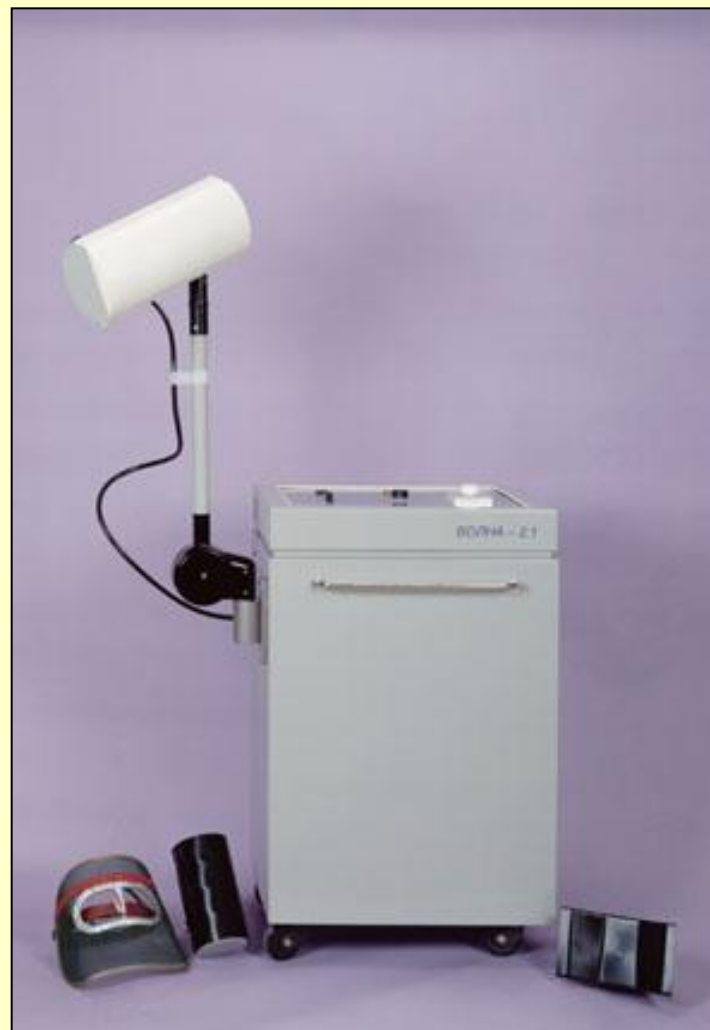
Физиотерапевтический аппарат Волна 2.1 Частота излучения 460 МГц Мощность 100 Вт
