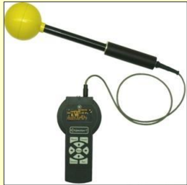
ПЗ-90 Диапазон частот: 50 Гц-300 МГц; погрешность 30%
