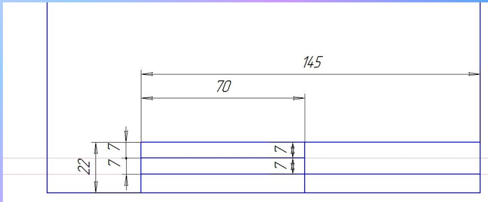
4. Отложить по вертикальным сторонам прямоугольника сверху последовательно два отрезка по 7 мм.
