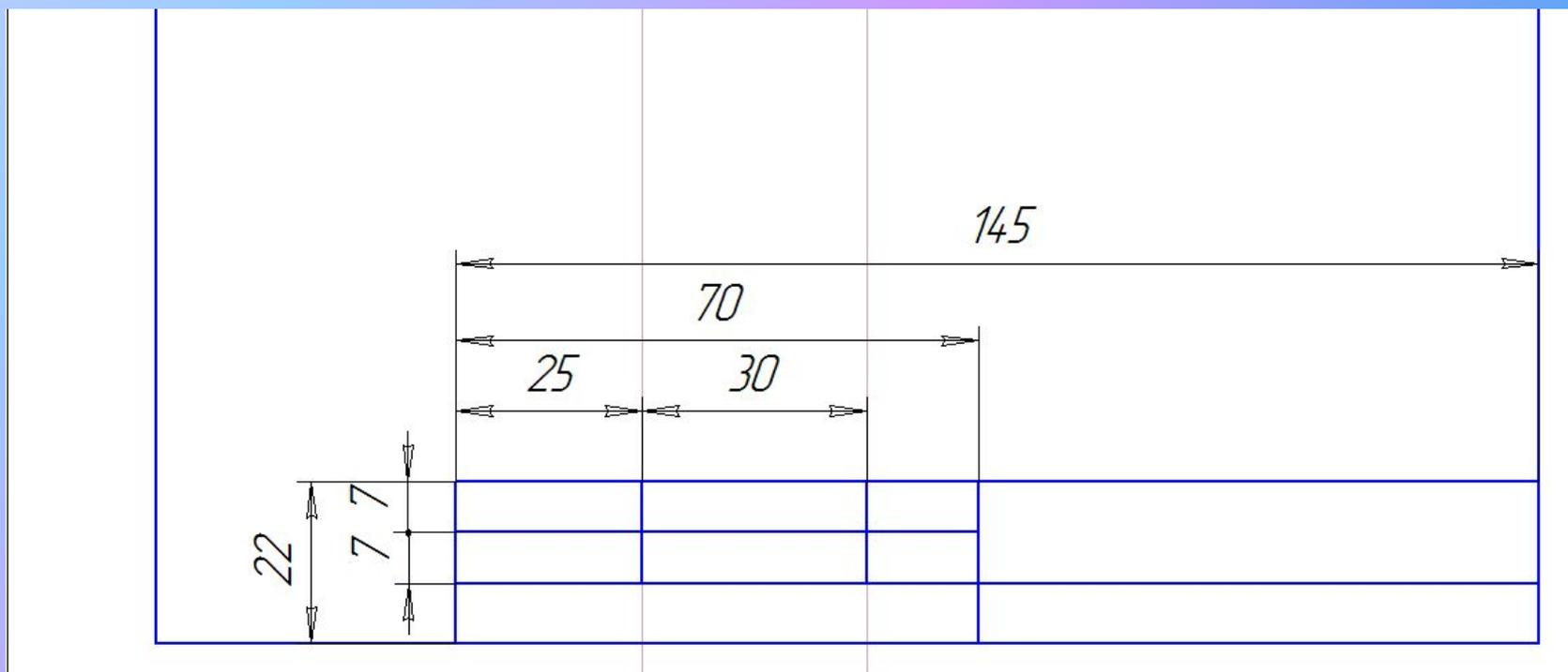
6. Отложить от левой вертикальной стороны прямоугольника два отрезка равные 25мм и 30мм.
