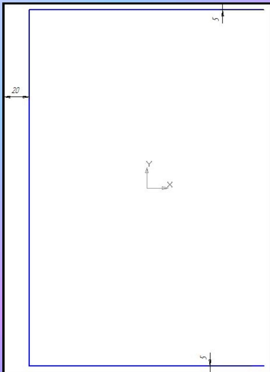
Провести линию параллельно нижней горизонтальной стороне на расстоянии 5 мм.
