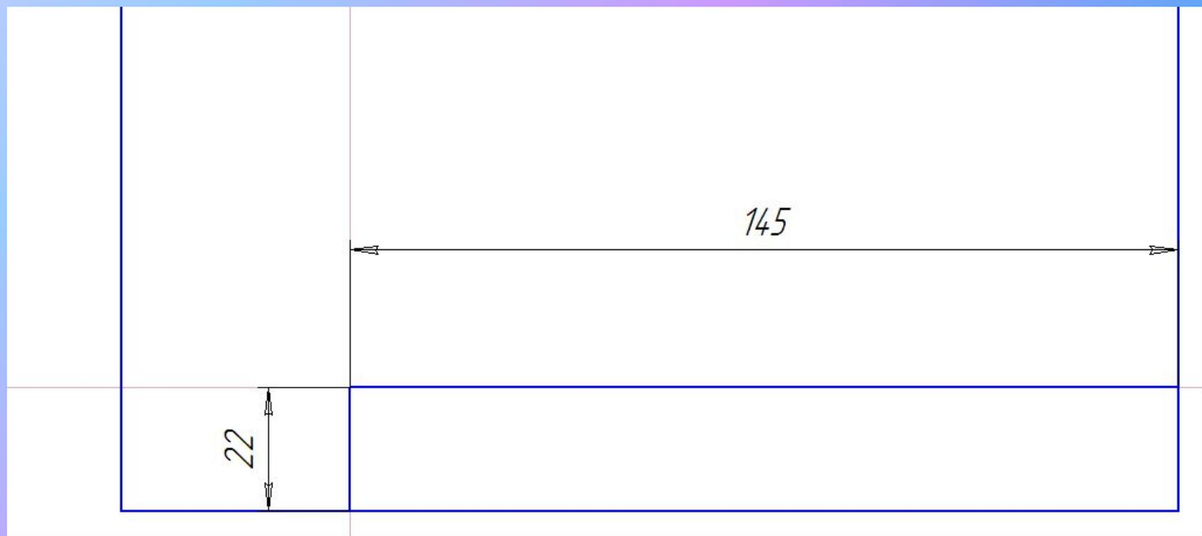
1. Провести линию параллельно нижней горизонтальной построенной линии на расстоянии 22 мм.
