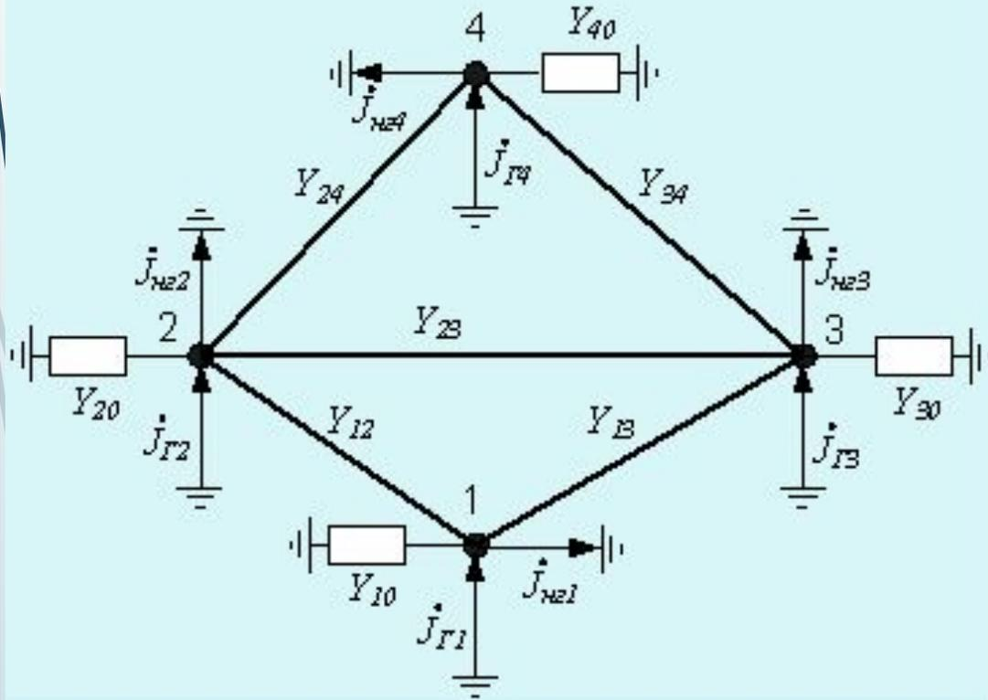
Напряжение  $U_4$  в базисно-балансирующем узле - задано
