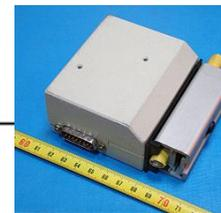
Подключение трансивера к кабелю при помощи разъемов, имеющих веселенькое название "вампиры" (это из-за того, что разъем прокалывает кабель до центральной жилы). Подключение производится без остановки работы сети, в отличие от подключения через N-коннектор. Кабели в сегменте должны браться с одной катушки кабеля, что обеспечивает одинаковые электрические параметры.
