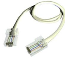
Стандарт принят в 1991 году, как дополнение к существующему набору стандартов Ethernet, и имеет обозначение 802.3L. Сети 10Base-T используют в качестве среды две неэкранированные витые пары (Unshielded Twisted Pair, UTP).
