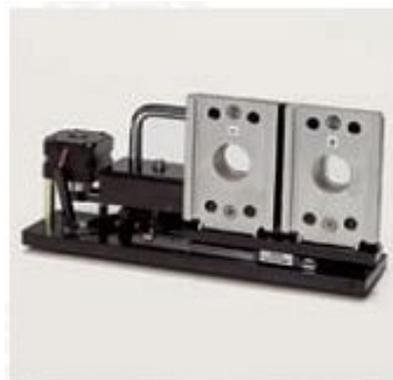
Рис.42. Автоматизированная приставка для измерения спектров пропускания вар1
