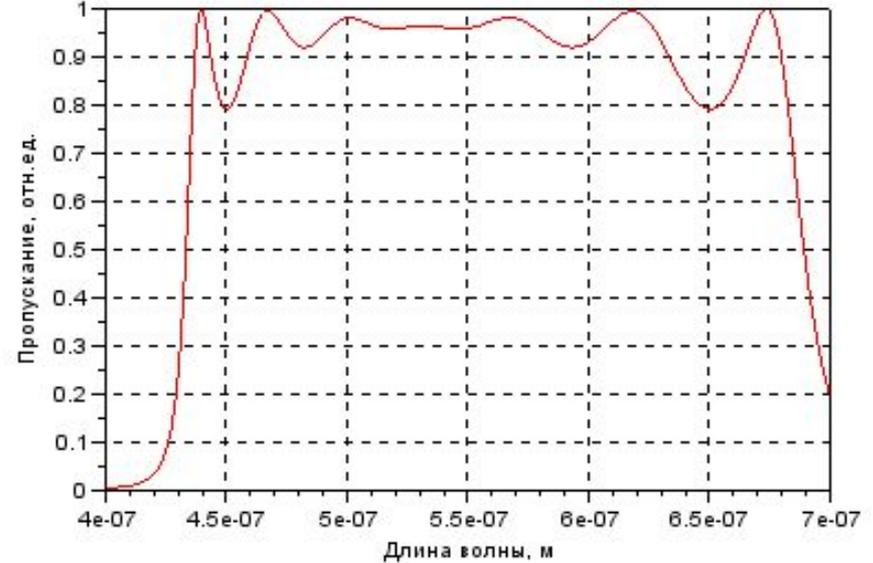
Рис.7. Расчет спектрального пропускания  $T(\lambda)$  для 16 слоев  $\text{SiO}_2$  /  $\text{TiO}_2$  с показателями преломления  $n_0=1$ ,  $n_1=1.45$ ,  $n_2=2.40$ ,  $n_m=1.45$
