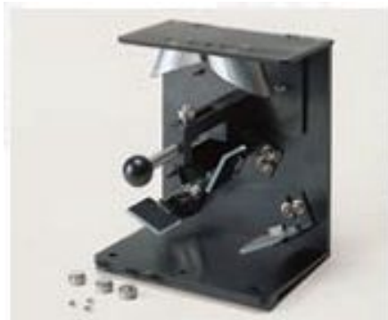
Рис.38. Приставка измерения спектров отражения и пропускания рассеивающих образцов
