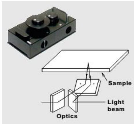
Рис.30. Приставка измерения отражения для спектрофотометра
