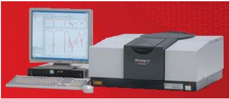
Рис.33. Лабораторный спектрофотометр Shimadzu IRPrestige-21
