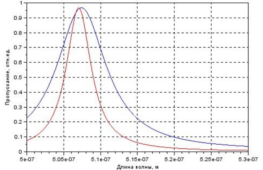
Рис.13. Спектр пропускания  $T(\lambda)$  при угле падения  $30^\circ$  для покрытия НВНВНВНВ-2Н-ВНВНВНВН: красный – s-поляризация, синий – p-поляризация
