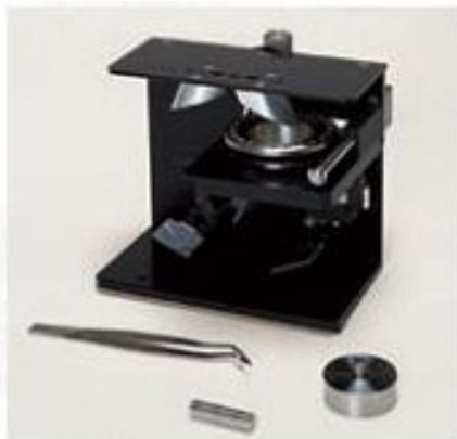
Рис.41. Автоматизированная приставка измерения спектров отражения и пропускания рассеивающих образцов
