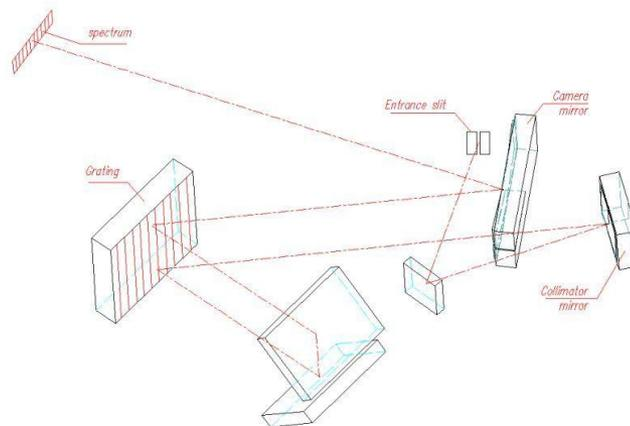
Рис.18. Оптическая схема Черни-Тернера
