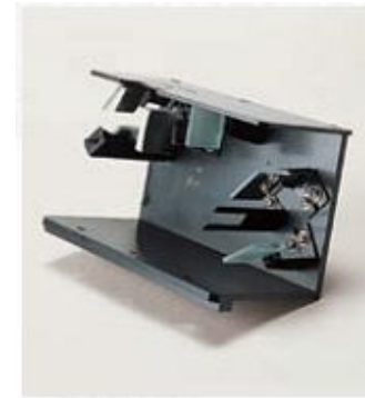
Рис.40. Приставка измерения спектров поглощения отражения плоских зеркальных образцов
