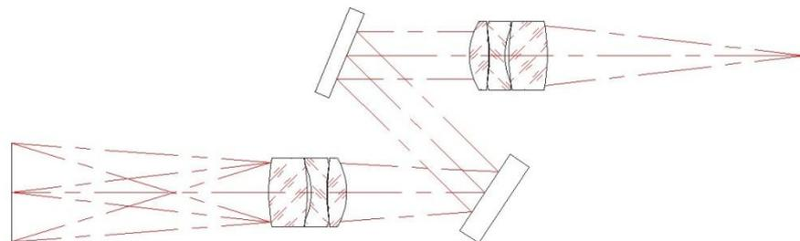
Рис.15. Оптическая схема спектрометра S41
