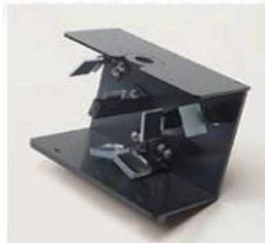
Рис.39. Приставка измерения спектров отражения плоских зеркальных образцов
