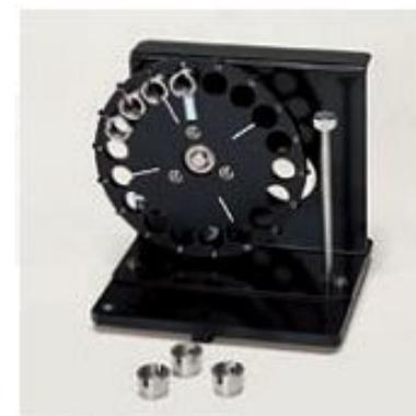
Рис.43. Автоматизированная приставка для измерения спектров пропускания вар2
