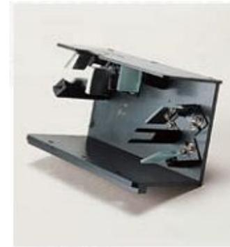
Рис.40. Приставка измерения спектров поглощения отражения плоских зеркальных образцов
