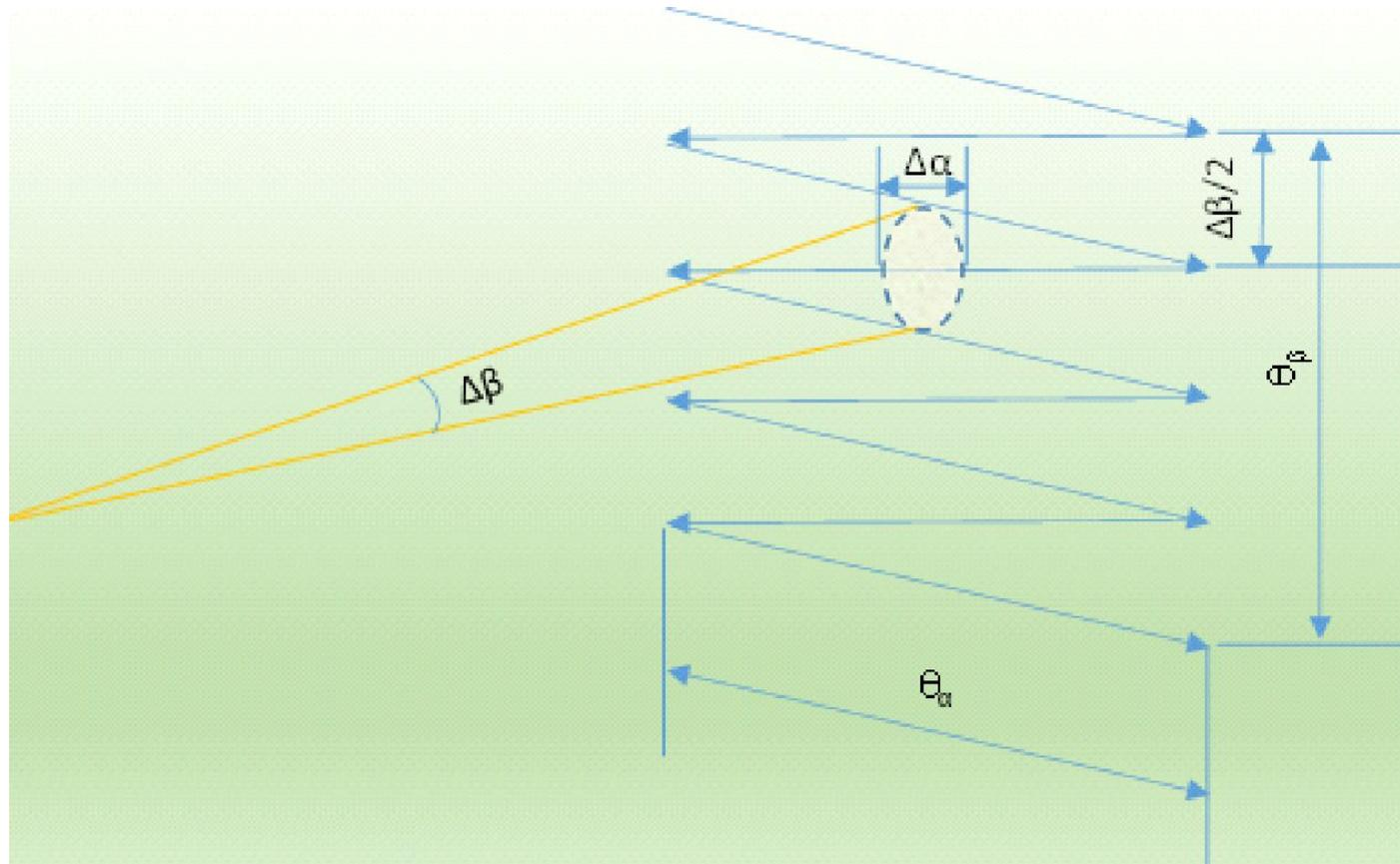
Механическое вращение ограничивает скорость обзора. Необходимо применять электронное сканирование и параллельный адаптивный обзор.
