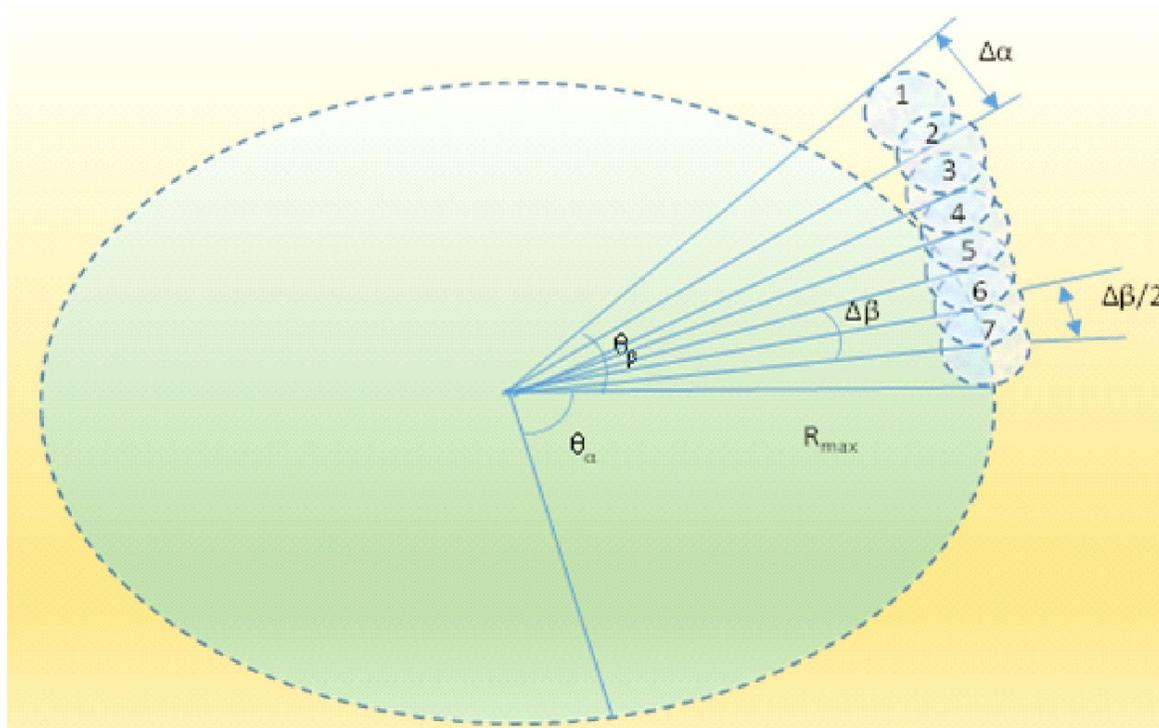
Если не применять механическое вращение сектор обзора не может быть больше 120°(реально 90°). В системах с электронным сканированием реализуют либо набор ФАР, повернутых в разные направления, либо используют ФАР сферической или цилиндрической формы.
