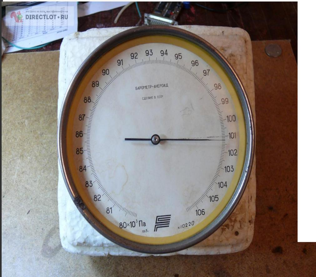
Рис. 21. Барометр -
