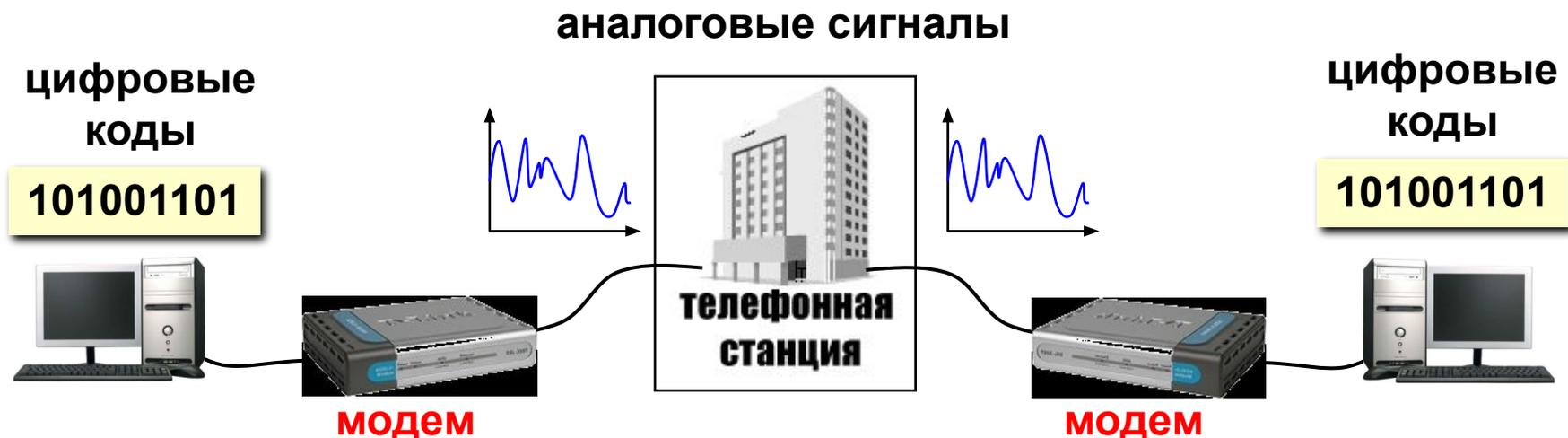
**Модем** – устройство для связи двух компьютеров с помощью телефонной линии.
