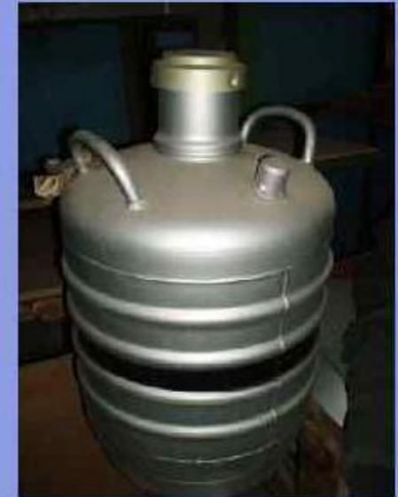
**ДЬЮАРА СОСУД**, колба с двойными посеребренными изнутри стенками, из пространства между которыми выкачан воздух. Теплопроводность разреженного газа между стенками столь мала, что температура веществ, помещаемых в сосуд Дьюара, сохраняется постоянной долгое время. Предложен Дж. Дьюаром (1898). Небольшие сосуды Дьюара (в т. ч. бытовые термосы) изготавливают из стекла, больших объемов — из металла.
