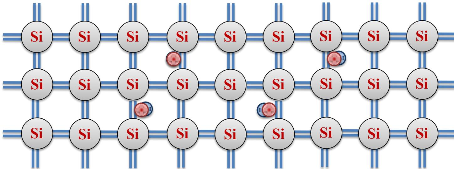
Полупроводники обладают **электронно-дырочной проводимостью**. Электронно-дырочная проводимость чистых полупроводников называется **собственной**.
