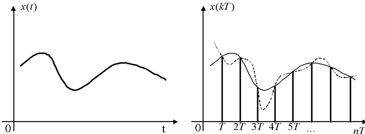
Дискретная функция отображает свойства непрерывной в фиксированные (дискретные) моменты времени
