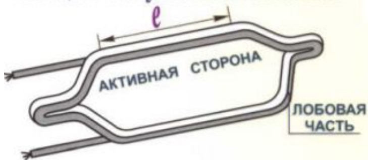
Секция катушечной обмотки
