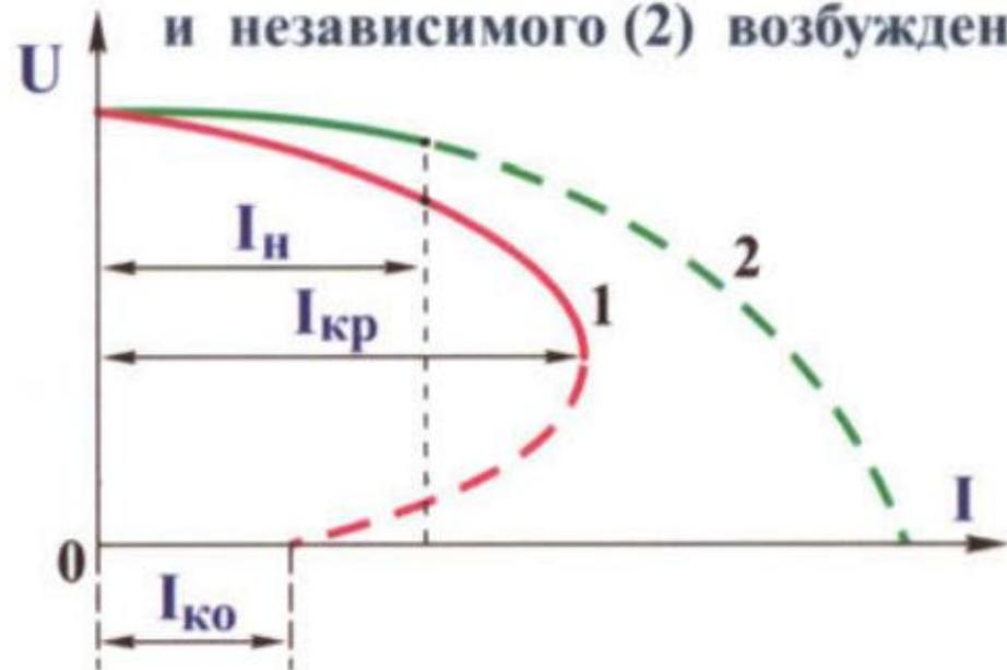
Сравнение внешних ( а ) и регулировочных ( б ) характеристик генераторов независимого( 1 ), параллельного( 2 ), смешанного возбуждения с согласным( 3 ) и встречным( 4 ) включением последовательной обмотки
