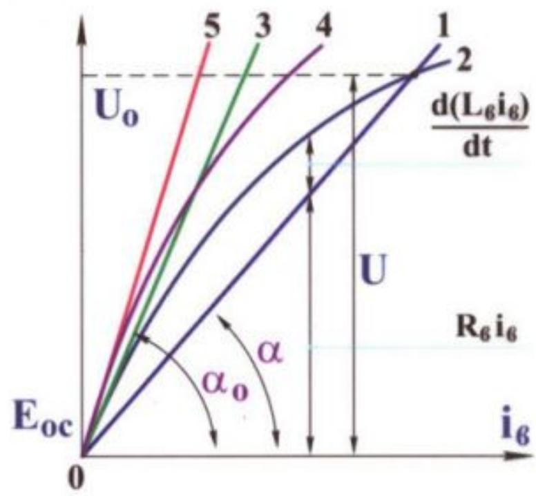
Характеристики холостого хода генератора параллельного возбуждения
