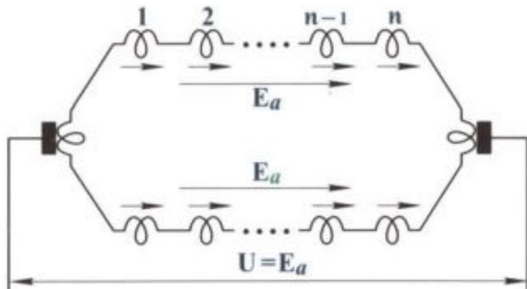
ЭДС витка  $e_x = 2B_{\delta x} e_{\delta} v$ .
