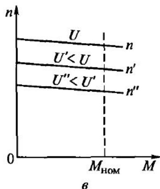
Механические характеристики двигателя постоянного тока независимого (параллельного) возбуждения:
