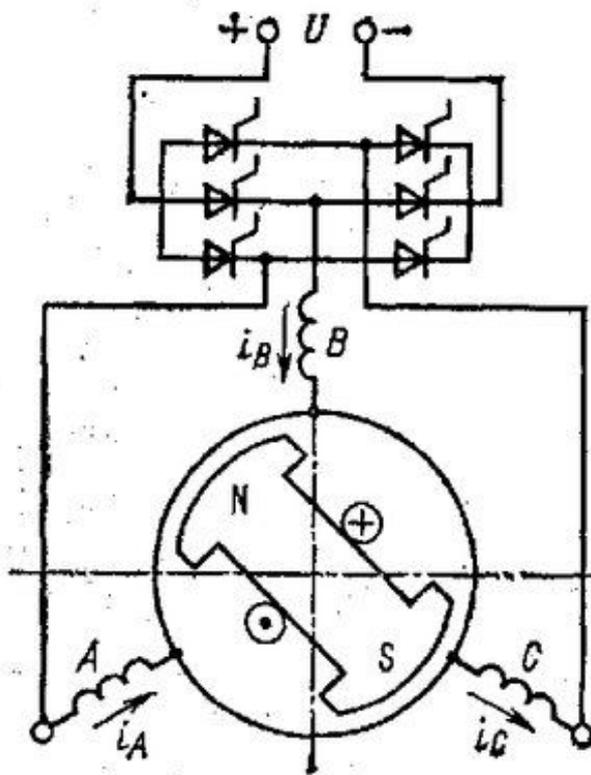
Система вентиляльной коммутации обычно состоит из датчика синхронизирующих сигналов, системы формирования сигналов управления и управляемого коммутатора.
