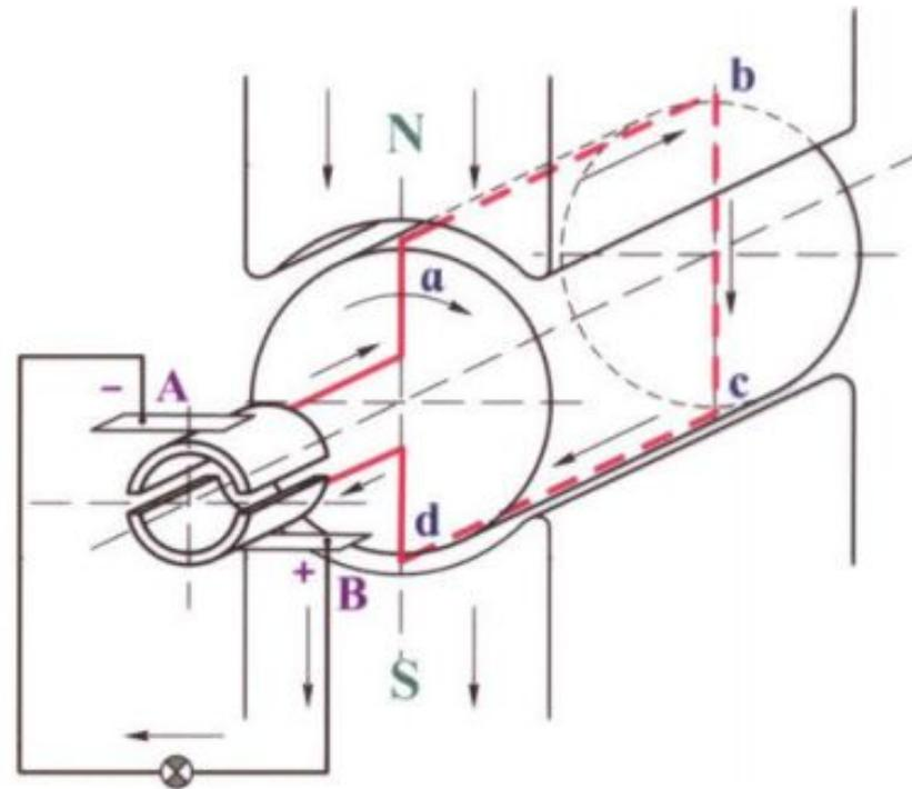
Схема работы машины
