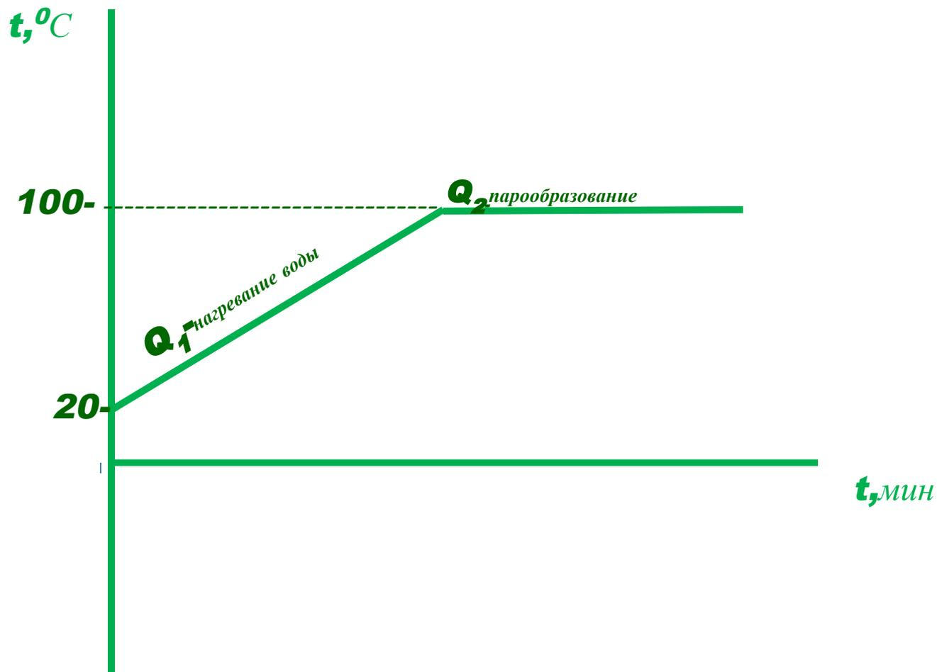
**Задача №1.** Какое количество теплоты потребуется, чтобы **29** кг воды, взятой при температуре **20**  $^{\circ}\text{C}$ , нагреть до кипения и обратить в пар?
