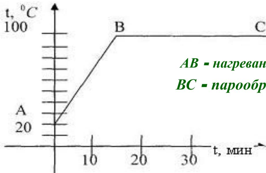
*AB - нагревание воды от **20 $^{\circ}\text{C}$**  до **100 $^{\circ}\text{C}$** .
