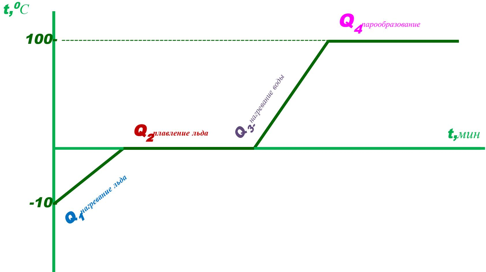
**Задача №3.** Определите количество теплоты необходимо для превращения **300** кг льда, взятого при температуре **-10 °C** в пар при температуре **100 °C**.
