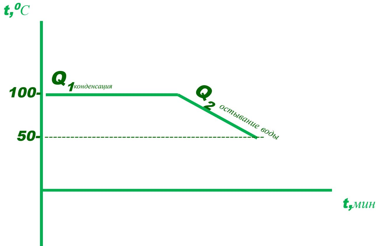
**Задача №2.** Какая энергия выделяется при конденсации водяного пара массой **3** кг, имеющего температуру **100 °С**, и охлаждении получившейся воды до температуры **50 °С**?
