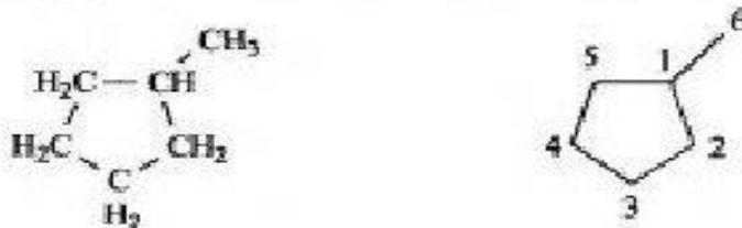
**Рис. 15.** Молекулярная структура и соответствующий топологический граф метилциклопентана.
