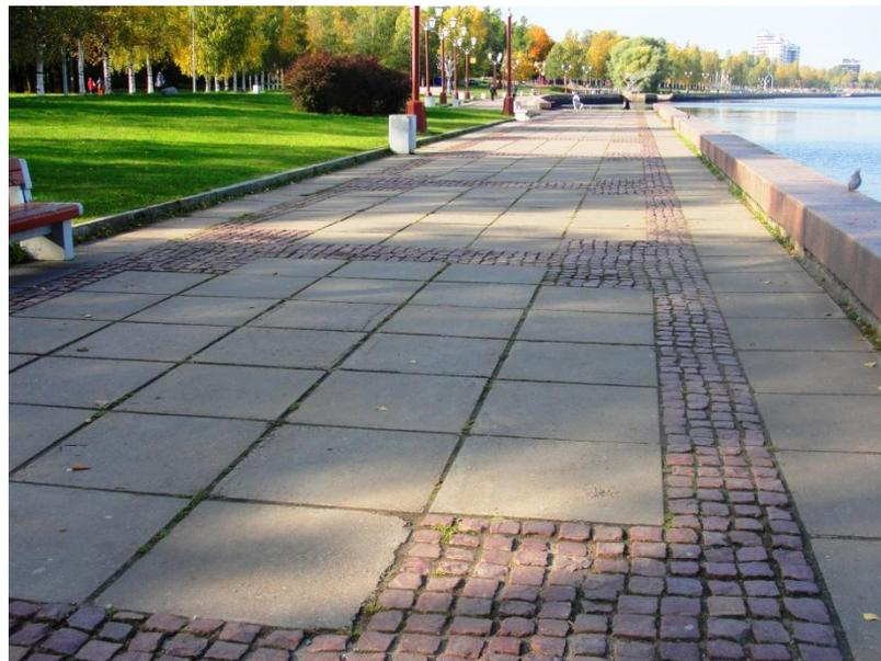
*Брусчатка* – дорожно-строительное изделие в виде брусков, которое используют для покрытий автомобильных дорог, мощения улиц и площадей. Используемая высота бруска бывает 100, 130, 160 мм, ширина 100, 125 мм, длина 200 и 250 мм.
