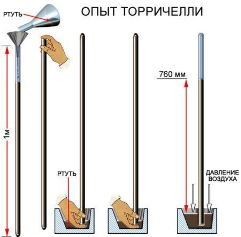
СХЕМАТИЧЕСКОЕ УСТРОЙСТВО РТУТНОГО БАРОМЕТРА
