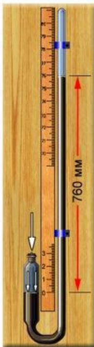
СХЕМАТИЧЕСКОЕ УСТРОЙСТВО РТУТНОГО БАРОМЕТРА
