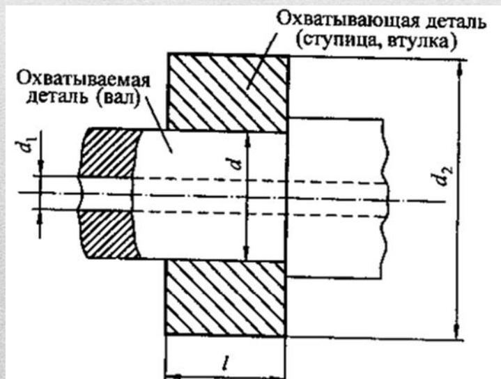
Посадка с натягом - посадка, при которой размеры вала больше размера отверстия до сборки.
