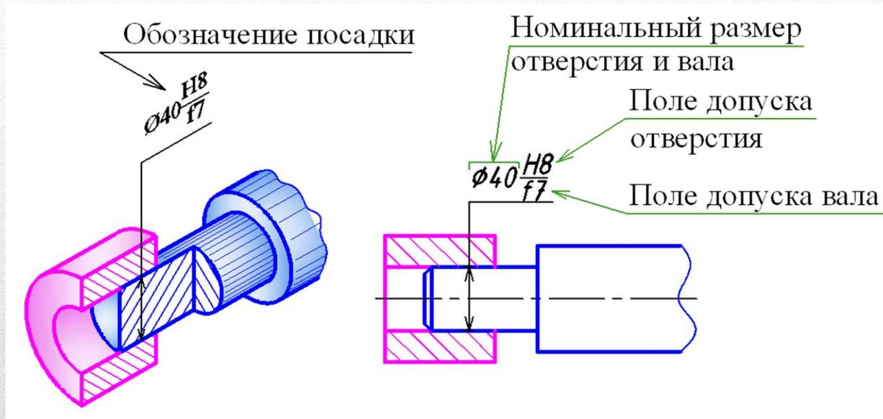
Посадки с натягом предназначены для неподвижных неразъемных соединений без дополнительного крепления винтами, штифтами и др.
