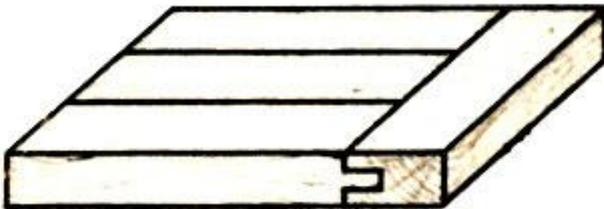
***С вклеенным наконечником*** – с торцов щит скреплен рейкой, прямоугольной или треугольной формы, которая на клею вставляется в паз, выбранный в торце щита. Этим способом скрепляют толстые щиты. Толщина рейки должна равняться примерно 0,4—0,5 толщины щита. Это соединение так же применяют для предохранения щита от коробления.
