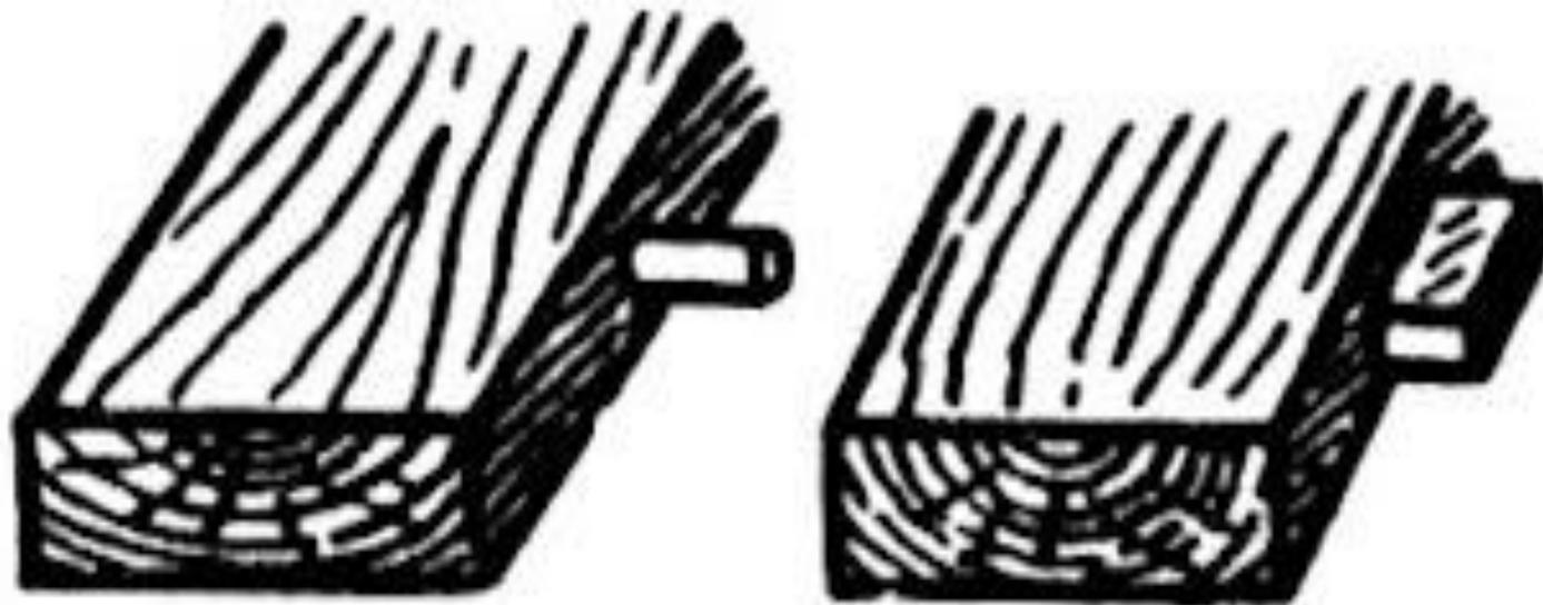
***В четверть*** - в кромках соединяемых деталей выбирают до половины их толщины и такой же ширины продольные выемки - четверти.
