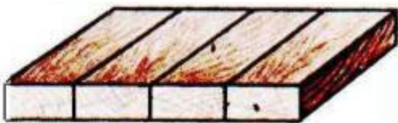
***На шипах и шкантах*** , когда в кромках плотно прифугованных деталей, выбирают гнезда или высверливают отверстия, в которые вставляют прямоугольные шипы (домино) или круглые (шканты) на клею. Толщина шипов не должна превышать  $\frac{1}{3}$  толщины соединяемых деталей.
