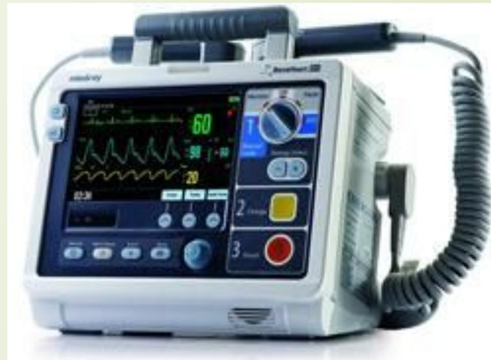
профессиональный двухфазный дефибриллятор-монитор, сочетающий в компактном и легком корпусе ручную и автоматическую дефибрилляцию, монитор и кардиостимулятор
