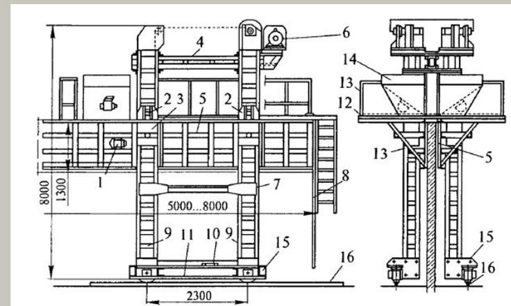
Катучая опалубка для бетонирования стен:
