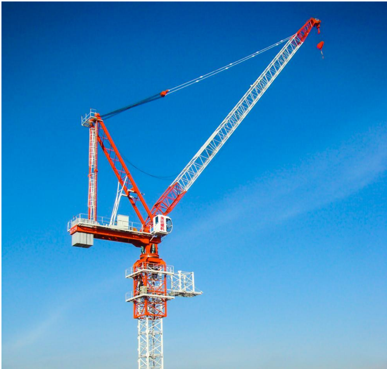
◎ Кран со стрелой подъёмного типа.
