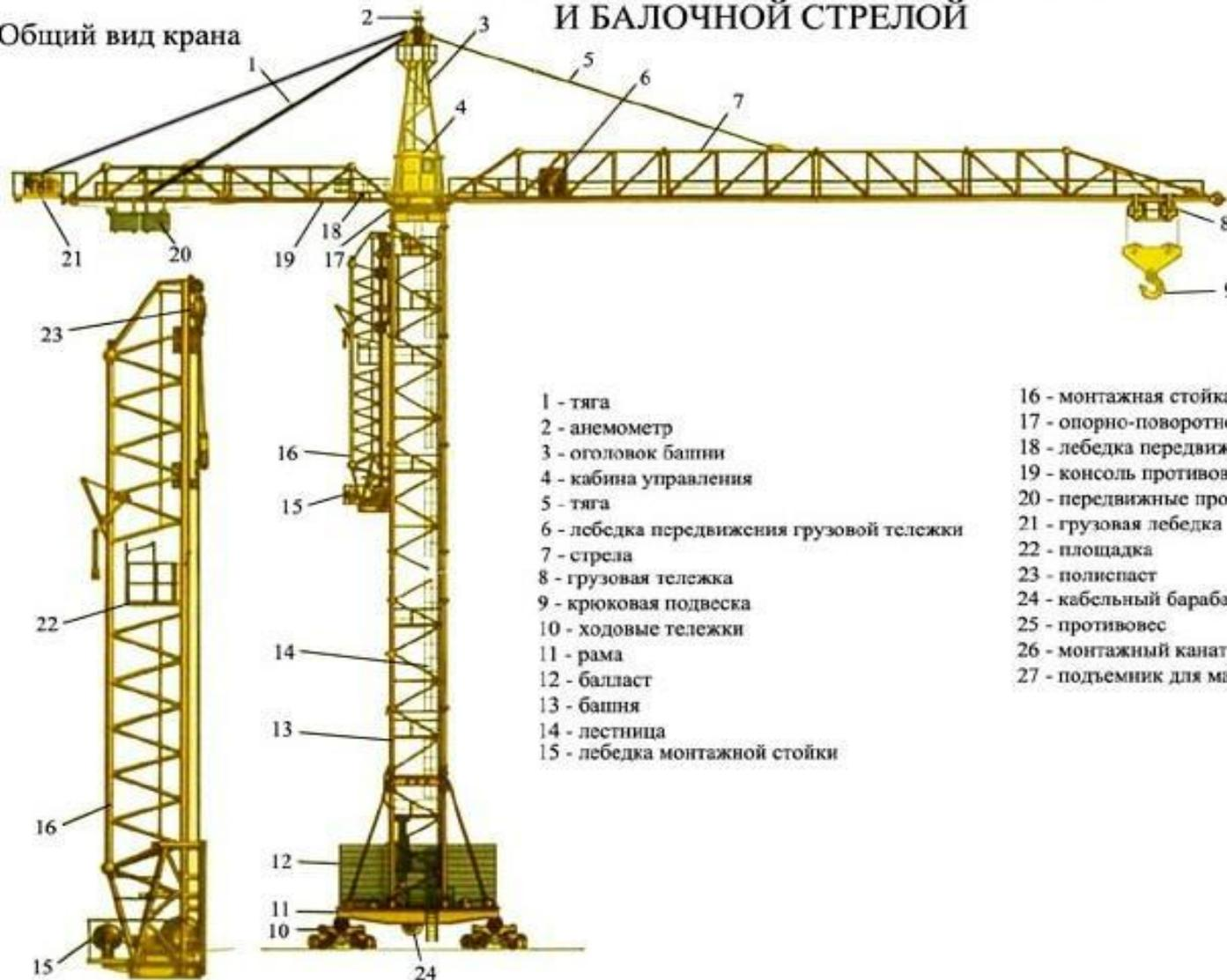
⦿ Работа башенного крана обеспечивается объединением в единой конструкции нескольких базовых элементов
