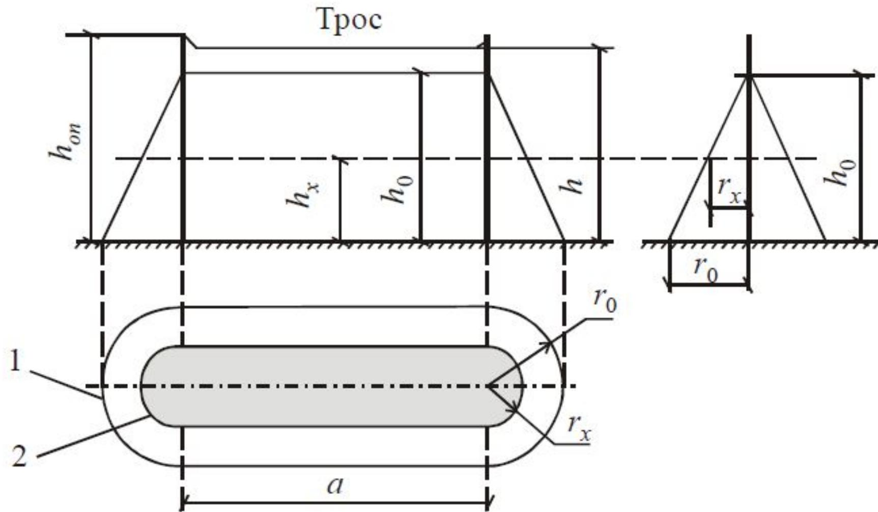
Рис.45.2 Зона защиты одиночного тросового молниеотвода:
