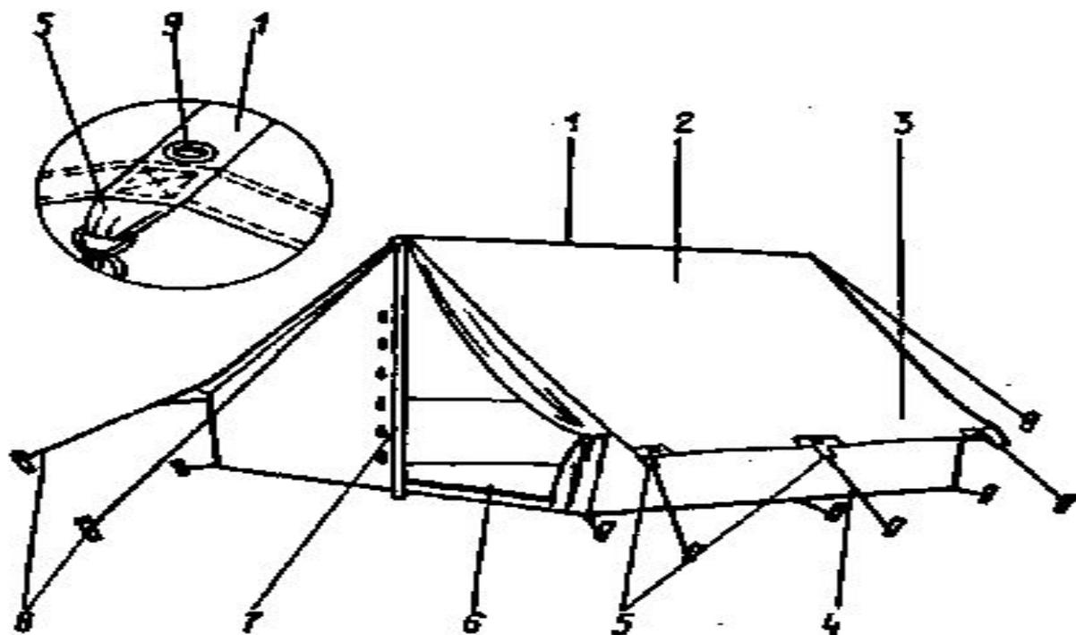
**Рис. 4.** Туристическая палатка: 1 — конек, 2 — боковой скат, 3 — крыло, 4 — боковая стенка, 5 — проушины, 6 — пол, 7 — опорная стойка, 8 — оттяжки, 9 — люверс.
