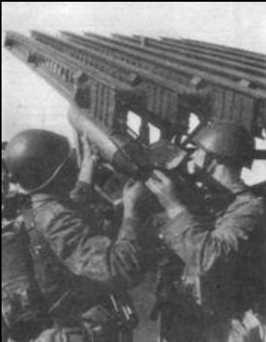
Установка БМ-13 образца 1941г. Представляла собой ферму из 16 направляющих (8 балок), на которой располагались 132-миллиметровые реактивные снаряды массой 42,5кг. Она монтировалась на трехосном грузовом автомобиле ЗИС-6. За несколько секунд установка выпускала 16 мощных снарядов (с каждой балки по 2 снаряда: один шел сверху, другой – снизу).
