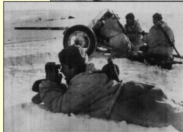
В связи с увеличением к лету 1942 года толщины брони основных немецких танков (Т-III и Т-IV) проведена модернизация основного ПТ орудия РККА. Орудие под обозначением: **45-мм ПТ пушка М-42 обр. 1942 г.** принято на вооружение **в октябре 1942 г.** Серийное производство начато в январе 1943 г.
