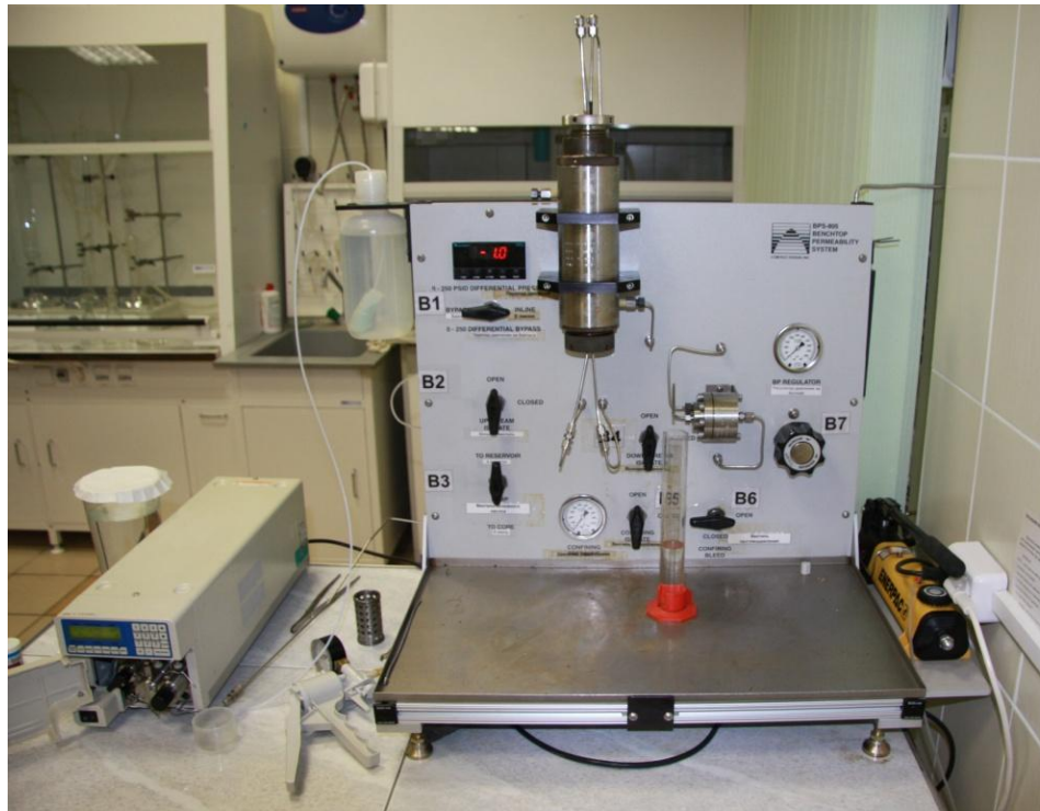
Настольная система для определения проницаемости пород BPS-805
