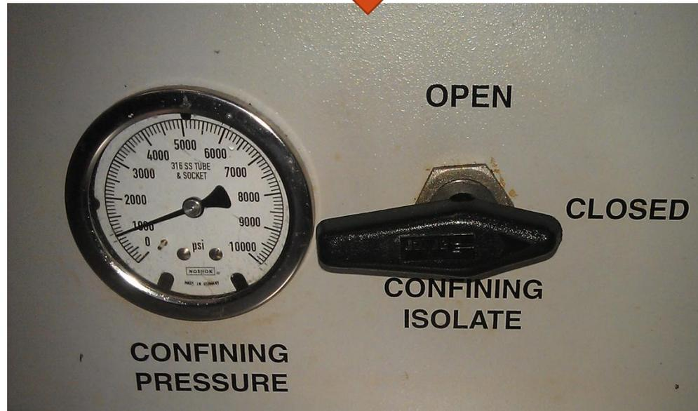
Устанавливаем кран гидрообжима в положение Closed
