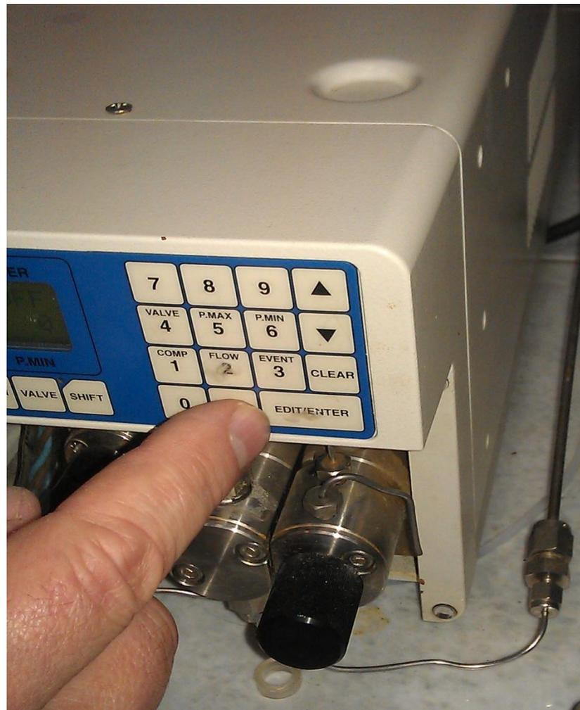
Кнопкой Pump запускаем насос в работу
