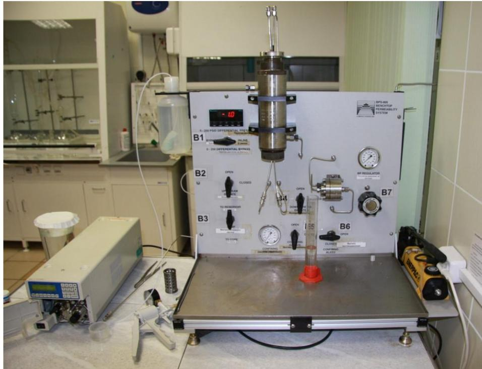
Настольная система для определения проницаемости пород BPS-805
