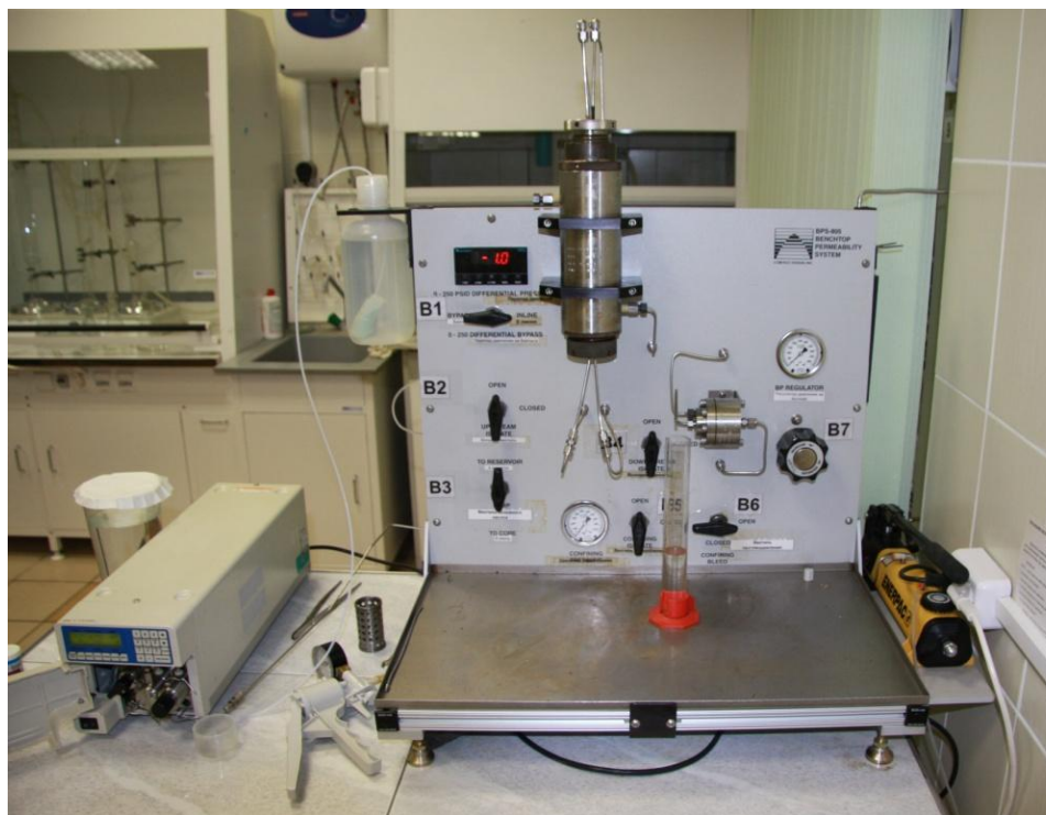
Настольная система для определения проницаемости пород BPS-805
