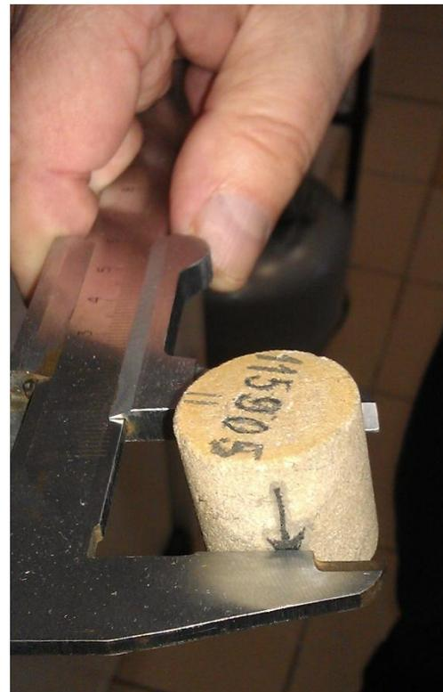
Измерение диаметра керна
