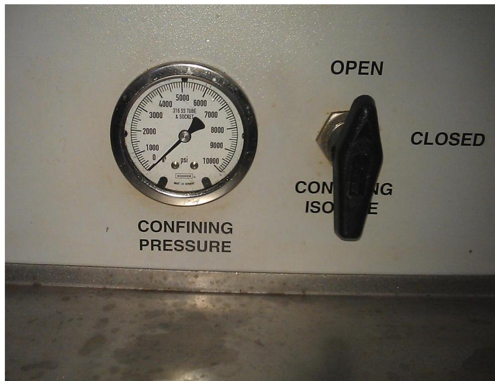
Сбрасываем давление гидрообжима до нуля
