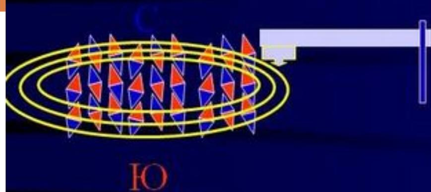
Поверхность диска покрыта ферромагнитными частицами металла. Каждая частичка имеет северный и южный полюс, как большие магниты.
