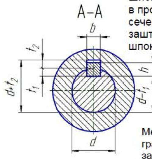
Шпоночное соединение изображают в продольном разрезе и поперечном сечении. В сечении все детали заштриховываются, на разрезе шпонки остается условно не рассеченной, а для вала выполняется местный разрез.
