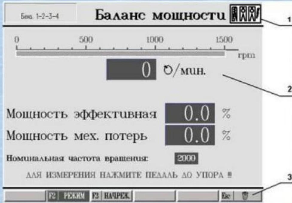
Ранее упоминалось про панель горячих клавиш, клавиш, являющихся по сути органами исполнения определенных команд - команд измерительного режима. При дальнейшей работе с комплексом все эти команды остаются постоянными и назначение каждой клавиши панели ( F1-F9 ) необходимо знать, в крайнем случае в нижнем меню измерительного экрана будет высвечиваться надпись ( к примеру ) – “ Нажмите F4 ”.
