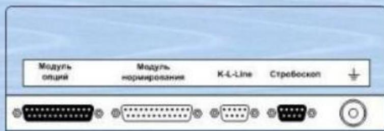
К модулю опций подключаются специальные датчики и жгуты. Эти датчики направлены на диагностирование форсунок двигателя, диагностирование давления топлива, температуры двигателя и т.д.
