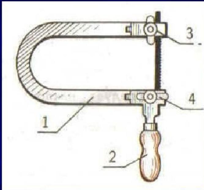
Лобзик см. рис. состоит из рамки 1 с ручкой 2, верхним 3 и нижним 4 зажимными винтами. Между зажимными винтами натягивается и крепится узкая и тонкая стальная *пилка* с наклоном зубьев в сторону ручки.
