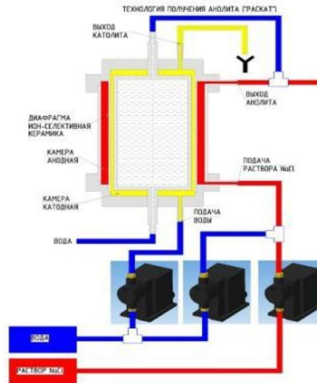
**Технологический процесс в электролизере:**
