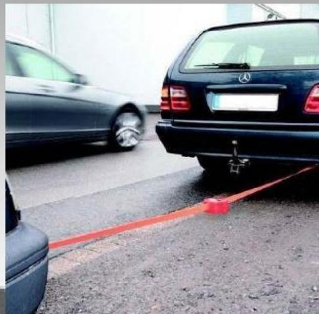
При буксировке на гибкой сцепке должно быть обеспечено расстояние между буксирующим и буксируемым транспортными средствами в пределах 4–6 м, а при буксировке на жесткой сцепке — не более 4 м.
