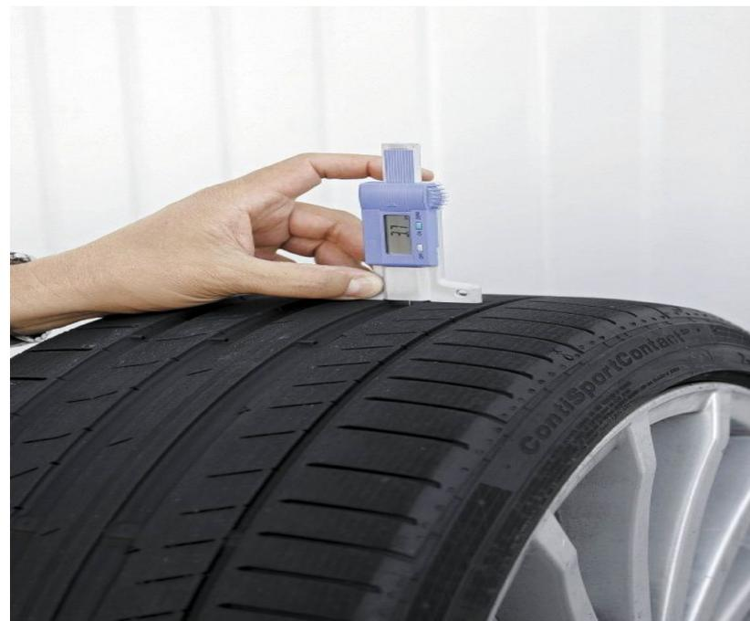
Рисунок протектора существенно влияет на сцепление шин с дорогой, поэтому не допускается устанавливать на одну ось шины с различным рисунком протектора
