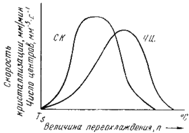
Рис. 3.6. Зависимость числа центров кристаллизации (а) и скорости роста кристаллов (б) от степени переохлаждения
