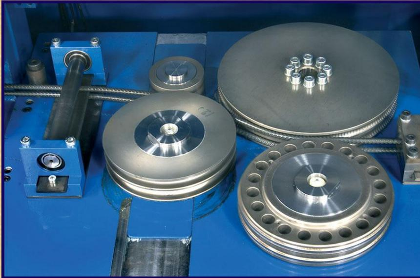
Устройство для снятия напряжений (опция) предназначено для правки труднообрабатываемого прутка.
