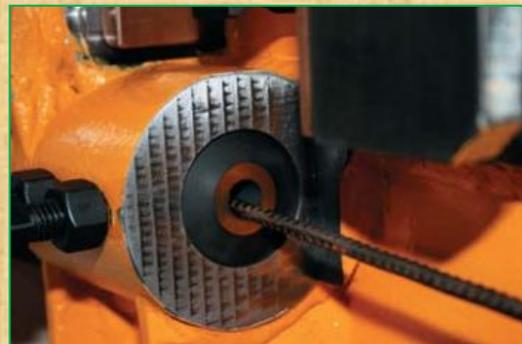
Гильотина приводится в движение отдельным приводом, что обеспечивает очень высокую скорость работы. Резка прутка производится вертикальным перемещением гильотины с высокой скоростью, Эта серия станков обеспечивает наибольшую точность длины стержня  $\pm 0,2$  мм
