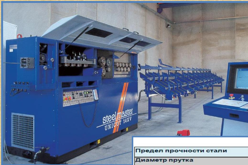
Правильно-отрезной автомат **Unicut 16 XV** предназначен для правки и резки прутка диаметром от 6 до 16 мм, подаваемого из бухт. В стандартной комплектации все правильно-отрезные автоматы Unicut оснащаются встроенным модулем предварительной подачи и устройством сбора прутков с двумя отделениями. По требованию возможно оснащение станка встроенным роликовым конвейером и сборными карманами.
