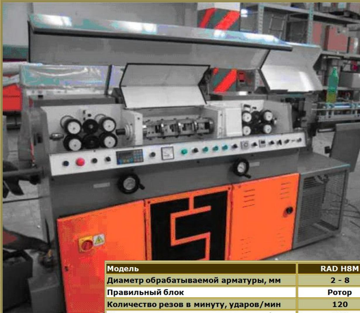
Правильно-отрезные станки серии RAD предназначены для автоматической правки бухтовой горячекатаной и холоднотянутой арматуры. Узел протяжки состоит из 2-х или 4-х пар протягивающих роликов с регулируемым давлением их прижима. Блок правки состоит из ротора, оснащенного вольфрам-карбидными сухарями. В зависимости от модели ротора комплектуется сухарями для обработки арматуры от 2 до 12 мм. Правильные сухари фиксируются в барабане ограничительными винтами.
