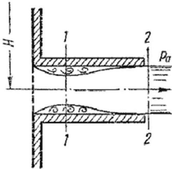
Внешним цилиндрическим насадком называется короткая трубка длиной, равной нескольким диаметрам без закругления входной кромки. Истечение через такой насадок в газовую среду может происходить в двух режимах.
