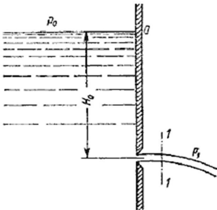
Рассмотрим большой резервуар с жидкостью под давлением  $P_0$ , имеющий малое круглое отверстие в стенке на достаточно большой глубине  $H_0$  от свободной поверхности. Жидкость вытекает в воздушное пространство с давлением  $p_1$ .
